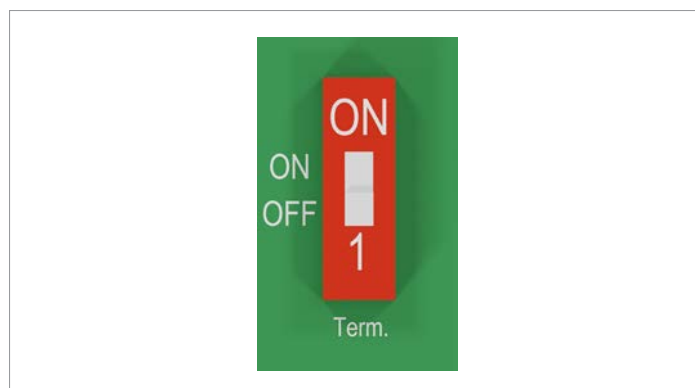
Fig. 7.3 : Commutateur DIP pour résistance terminale RS485
