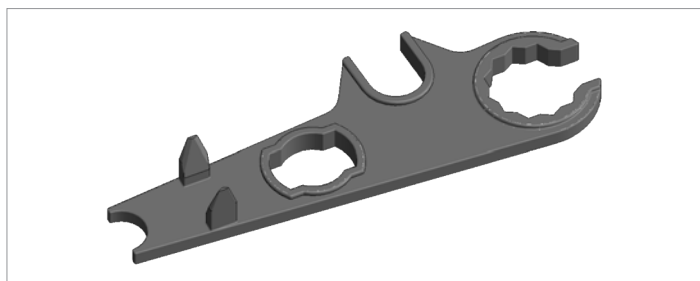
Fig. 7.11 : Clé de montage pour fiche DC (incluse dans la livraison)
